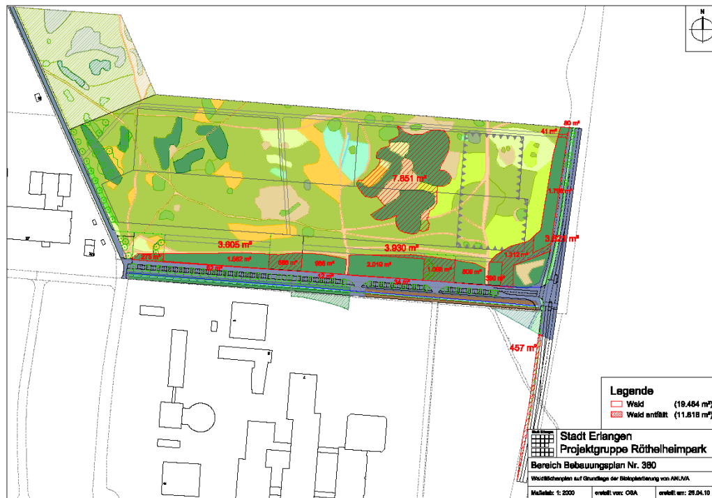
Abb. 4: Darstellung der innerhalb des Geltungsbereichs vorhandenen Waldflächen sowie der von der Planung betroffenen Flächen (Rodungsflächen)
